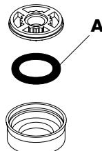
**D** Bei Problemen mit dem Durchlauferhitzer oder wenn mehr Wasserdurchsatz gewünscht wird, kann der EcoSmart® (Durchflussbegrenzer **A**), der hinter dem Luftsprudler sitzt entfernt werden.
